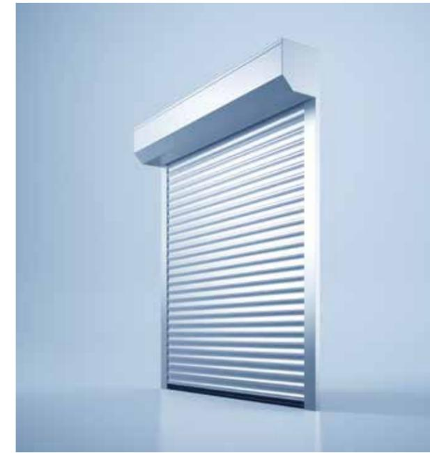
Das Rolltorensystem heroal RD 55 ist ein schmales System mit kleiner Kastengröße. Der rollgeformte Stab ist mit einer Deckbreite von 55 mm besonders schlank und eng wickelnd. Mit dem Rolltorensystem heroal RD 55 lassen sich Elemente mit einer lichten Durchfahrtsbreite bis zu 3.500 mm und einer lichten Durchfahrtshöhe von 3.000 mm realisieren. Das System kann entweder offen oder im geschlossenen Kastensystem montiert werden, wobei Kastengrößen von nur 254 mm zum Einsatz kommen können.
