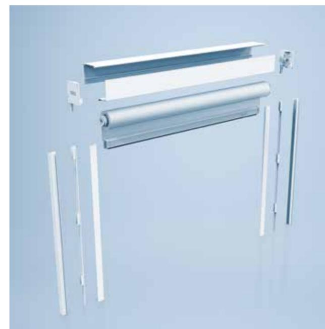
Le kit heroal Module textile complète les éléments du kit heroal Aluminium avec le module textile ainsi que l'insert de coulisse déjà scié sur mesure. Le module textile comprend une toile pré-confectionnée de la collection actuelle d'heroal, un tube d'enroulement coupé sur mesure, un moteur déjà monté de la gamme heroal au choix, une lame finale pré-assemblée avec des fers de lestage (type III) ainsi que tous les autres accessoires nécessaires comme la capsule du rouleau et le palier du moteur.
